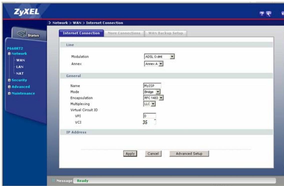
В открывшемся окне представлены основные параметры ADSL-соединения. Для настройки непосредственно ADSL-канала вводим параметры **VPI/VCI** (для г.Ташкента 0/35, для остальных регионов 0/33). *Multiplexing* – LLC (VC применяется очень редко). Так же, очень важный момент выбор модуляции (**Modulation**).
